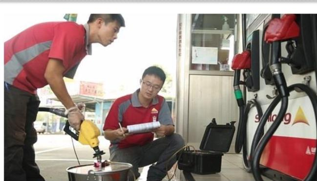
測漏管檢測
