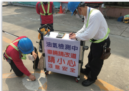
環整處：以加油站設施檢測，測漏管、氣油比、度量衡與氣漏測試等，公正專業技術服務客戶。
